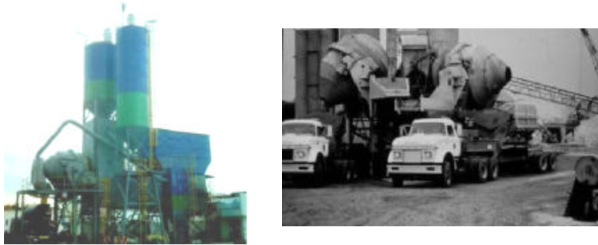
Figura Q.4 Plantas de mezclado central para la elaboración de concreto hidráulico.
