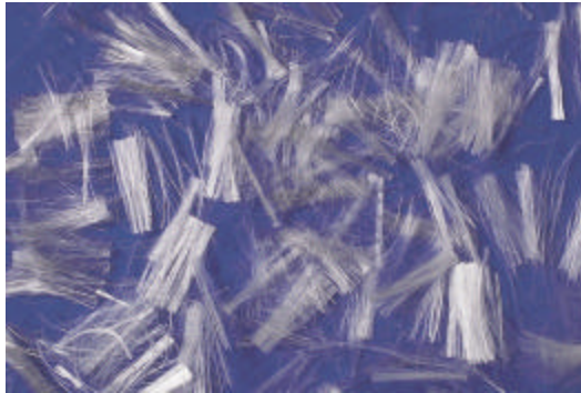
Figura R.1 Fibras en forma de multifilamentos para su utilización en el concreto hidráulico.
