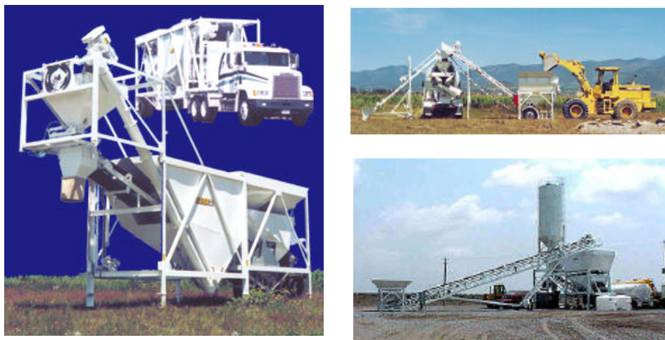
Figura Q.5 Plantas dosificadoras móviles para la elaboración de concreto hidráulico.
