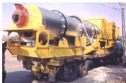
Figura O.2 Planta móvil para la elaboración de mezcla asfáltica.
