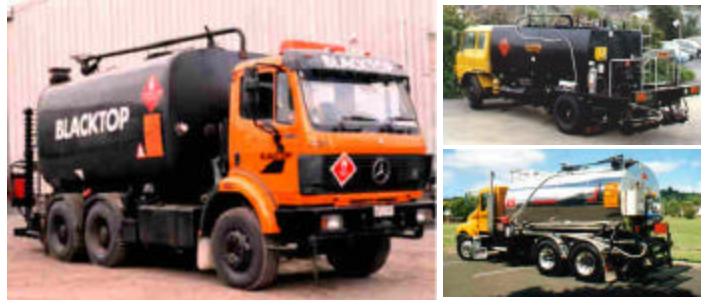
Figura K.1 Petrolizadoras típicas para aplicar el riego de impregnación.
