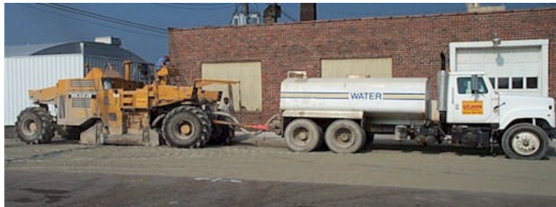
Figura G.2 Equipo autopropulsado utilizado para la estabilización de materiales.
