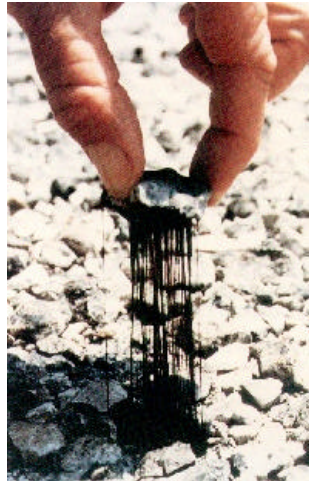
Figura J.1 Comportamiento de un material asfáltico modificado con polímeros.
