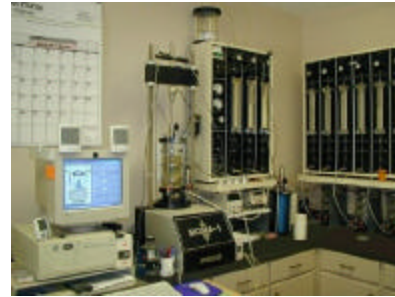
Figura Q.19 Laboratorio y equipo para verificación de la calidad de materiales, mezclas y pavimentos rígidos.
